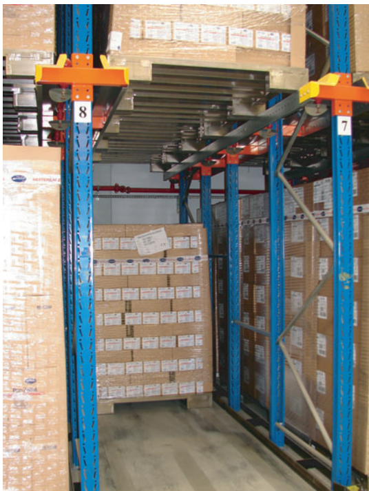
■ Uložení v drive in systému
