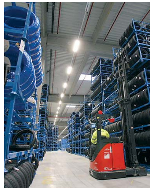
Manipulaci ve skladech zvládají vysokozdvizné vozíky - s rotačními kleštinami pro manipulaci s velkými pneumatikami, vidlicovými pro přemísťování skladovacích boxů
