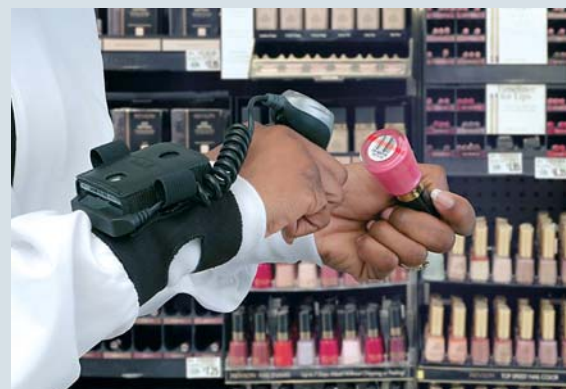
Kroužkový snímač na prst - A ring finger scanner Foto: LXE
