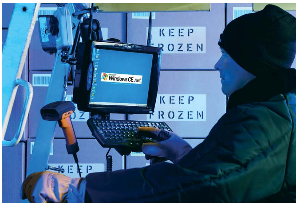
Mobilní počítač zabudovaný do vysokozdvizného vozíku - A mobile computer integrated in a fork lift
