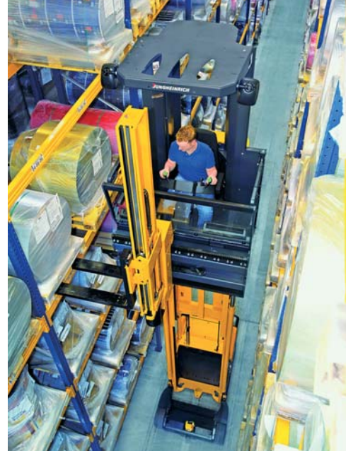
Jungheinrich vybavuje vozíky EKX technologií RFID pro inteligentní řízení a komunikaci se skladovým systémem
