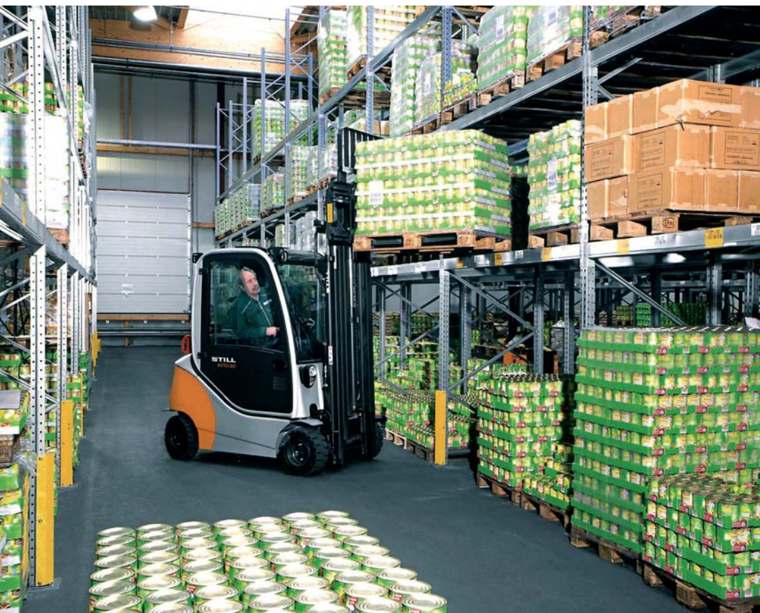
Kompaktní snadno ovladatelný vysokozdvizný vozík RX 70 existuje ve verzi s dieselovým a plynovým motorem pro nosnosti 1,6/ 1,8 a 2,0 tuny
