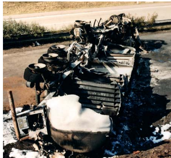
Torzo dopravní jednotky po výbuchu hořlaviny
